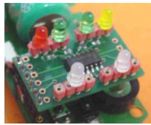
Interface pour piloter 8 diodes et assortiment de diodes pour le Bimo (kit à 12.-)
