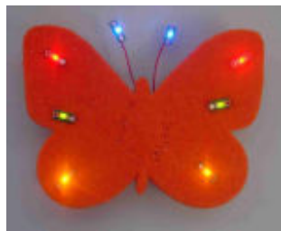
Le papillon avec module Orion, 8 diodes cousues sur du feutre (kit à 32.- avec accu Lipo et chargeur)
